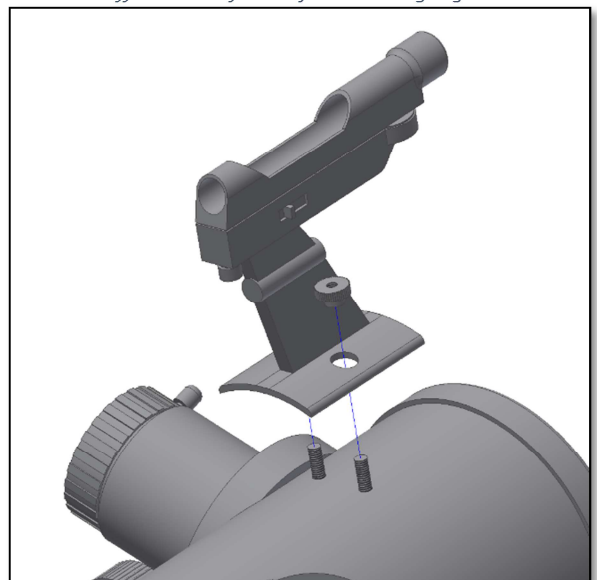
Abb. 11. Sucherfernrohr befestigen und Flügelmuttern.
