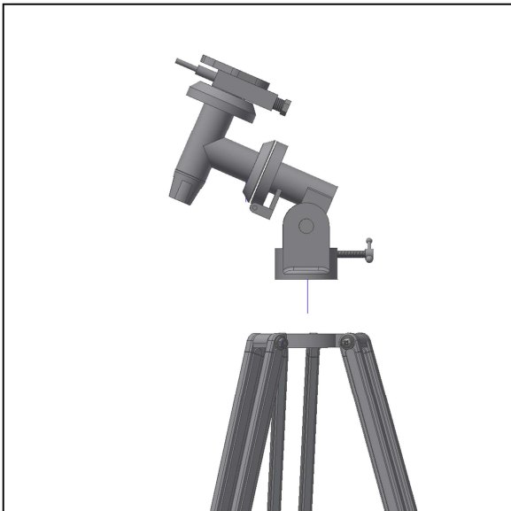
Abb. 4. Einbau der äquatorialen Montierung.
