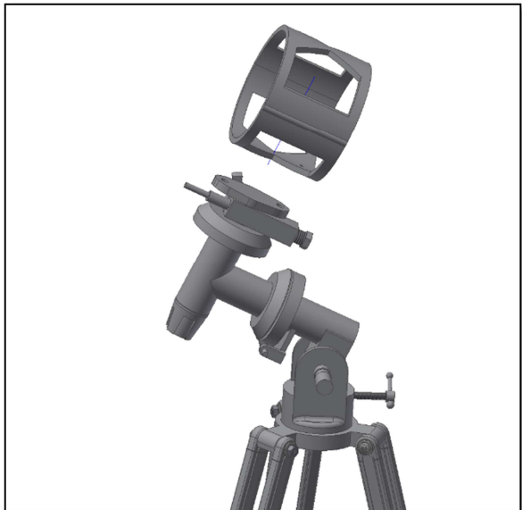
Abb. 5. Anbringung und Festziehen der Rohrschellen.
